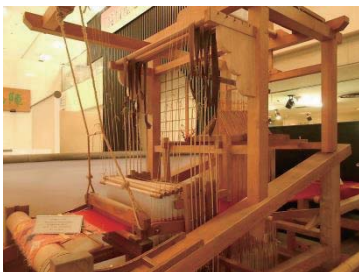
そらひきばた 空引機。二人で模様を織り上げる
